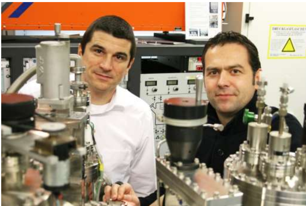
Sebastian T. B. Goennenwein und Stephan Geprägs an der Laser-Molekularstrahl-Epitaxie-Apparatur, mit der die ferrimagnetischen Dünnschichtproben am Walther-Meißner-Institut hergestellt werden (Bild: WMI).
