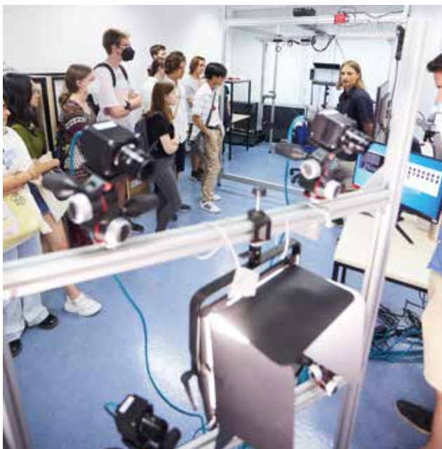
Führung in der Computer Vision Group von Daniel Cremers: Mithilfe einer Tiefenkamera lassen sich über neuronale Netze 3D-Modelle in sehr hoher Auflösung rekonstruieren.
