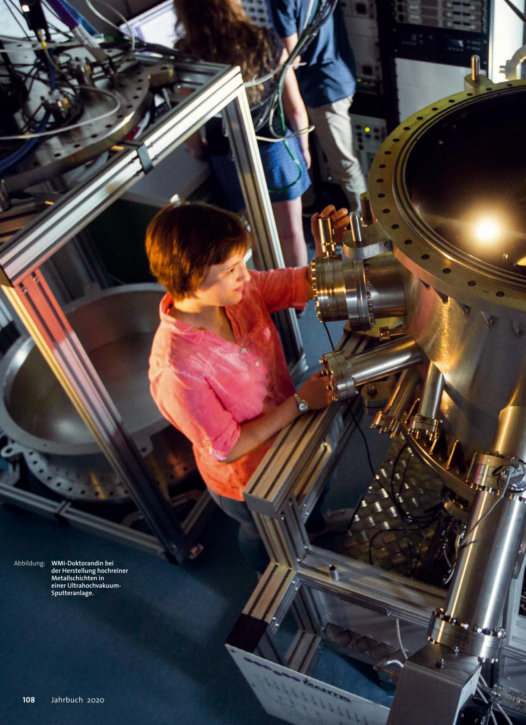
Abbildung: WMI-Doktorandin bei der Herstellung hochreiner Metallschichten in einer Ultrahochvakuum-Sputteranlage.
