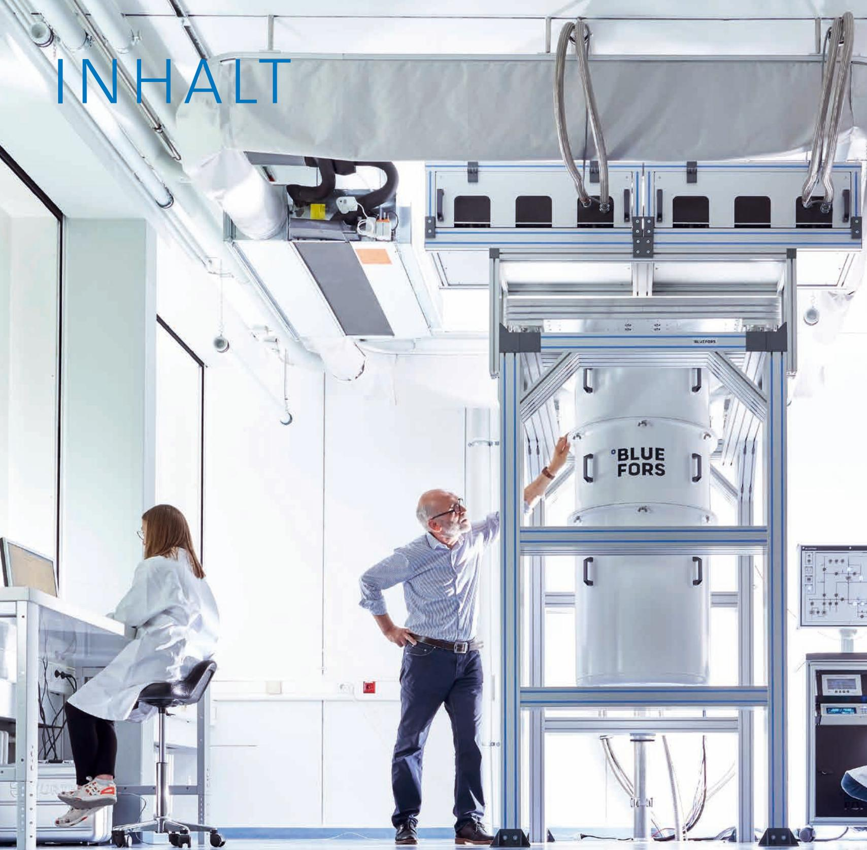
Abbildung: Tieftemperatursystem im WMI Quantencomputerlabor zur Untersuchung supraleitender Quantenschaltkreise. Das System wurde über den Exzellenzcluster MCQST finanziert.
