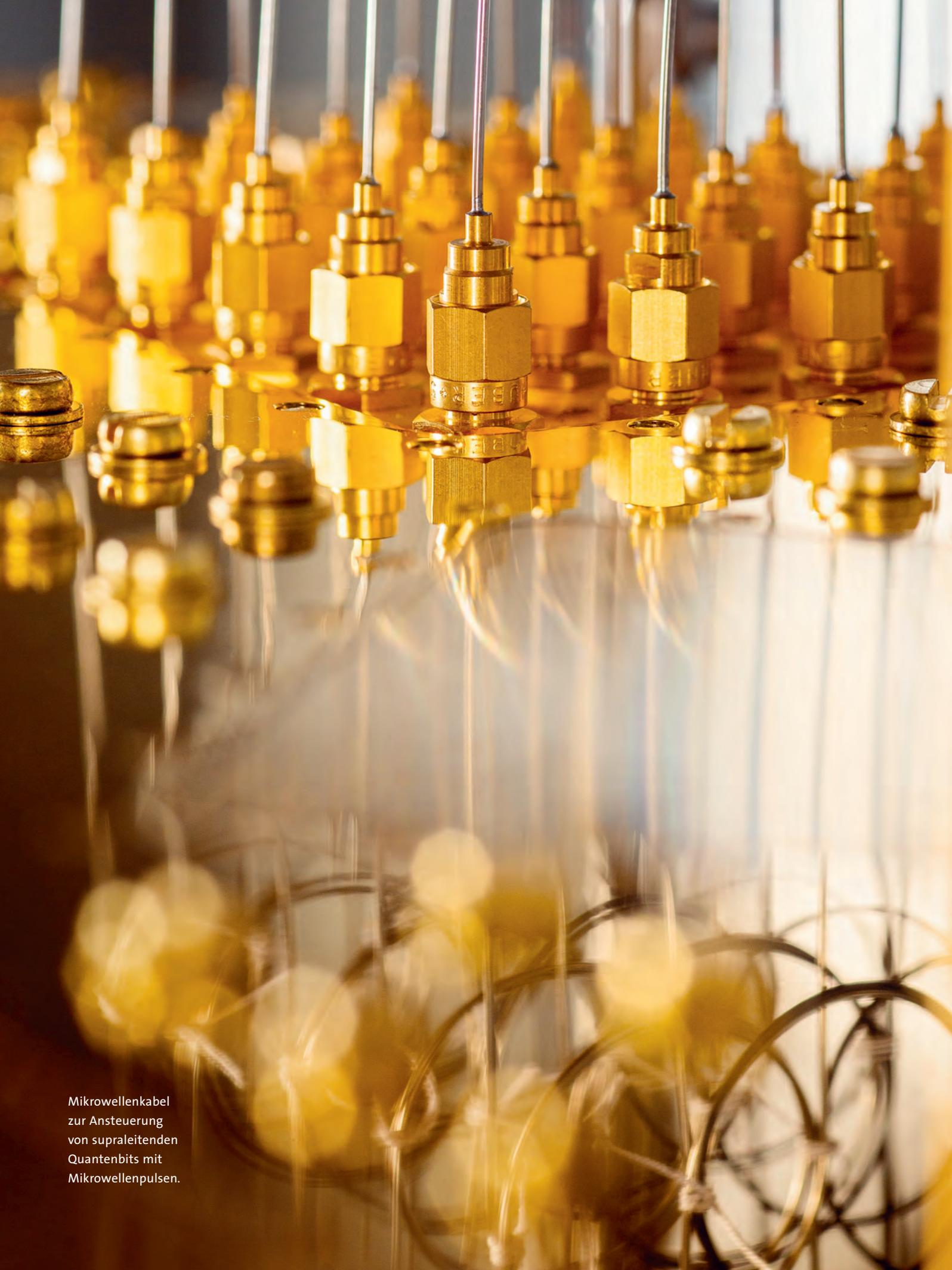
Mikrowellenkabel zur Ansteuerung von supraleitenden Quantenbits mit Mikrowellenpulsen.
