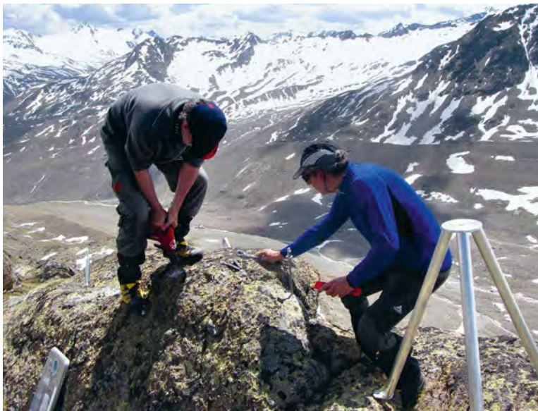
Aufbau der Messstation im Sommer 2010 auf dem Schwarzkögele: Das Stativ wird im Fels verankert.
