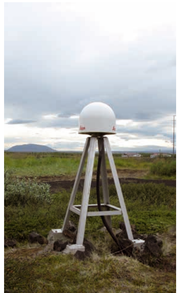
Abb. 4: Die GPS-Permanentstation MYVA im Nordosten Islands. Die 2006 eingerichtete Station beobachtet die Signale der Satellitensysteme GPS, GLONASS und Galileo.
