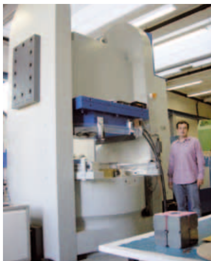
Das Hochdrucklabor am Bayerischen Geoinstitut. Hochdruckpressen produzieren einen Druck und eine Temperatur wie im Erdinneren durch die Fokussierung von tausenden von Tonnen auf wenige Millimeter.
