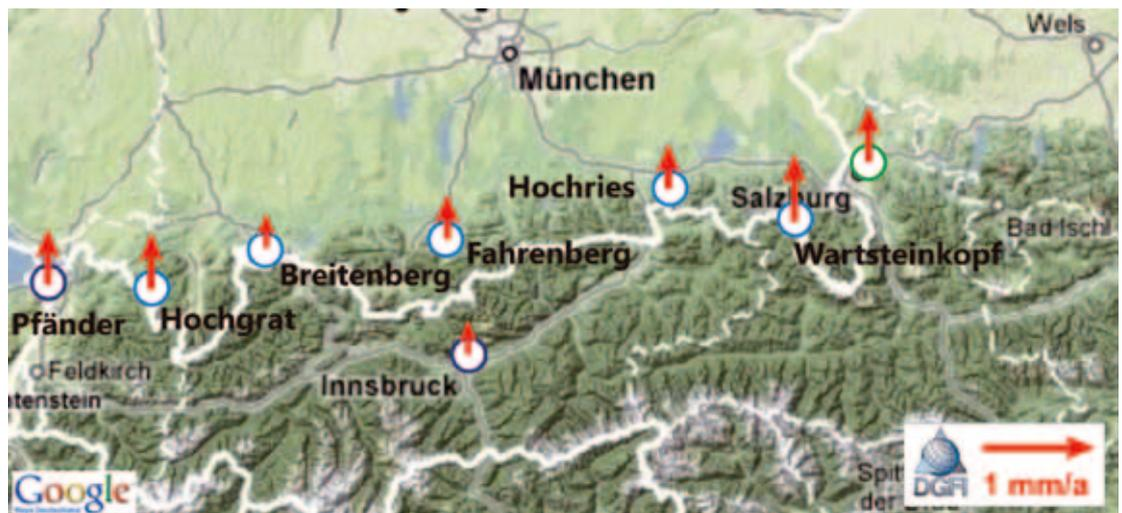
Rahmen eines Projekts der Europäischen Kommission (INTERREG III Alps GPS-Quakenet) fünf mit massiven Betonpfeilern vermarkte Stationen am nördlichen Rand der Alpen eingerichtet und deren Messungen mit dem Globalen Positionierungssystem (GPS) gemeinsam mit internationalen (IGS) und europäischen (EUREF) Stationen ausgewertet.
