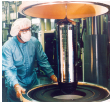
Abb. 8: Herstellung von Silizium-Einkristallen nach dem Czochralski-Verfahren. Links: fertiger Einkristall, Durchmesser 200 mm (Wacker Siltronic AG). Rechts: schematische Darstellung des Züchtungsprozesses.
