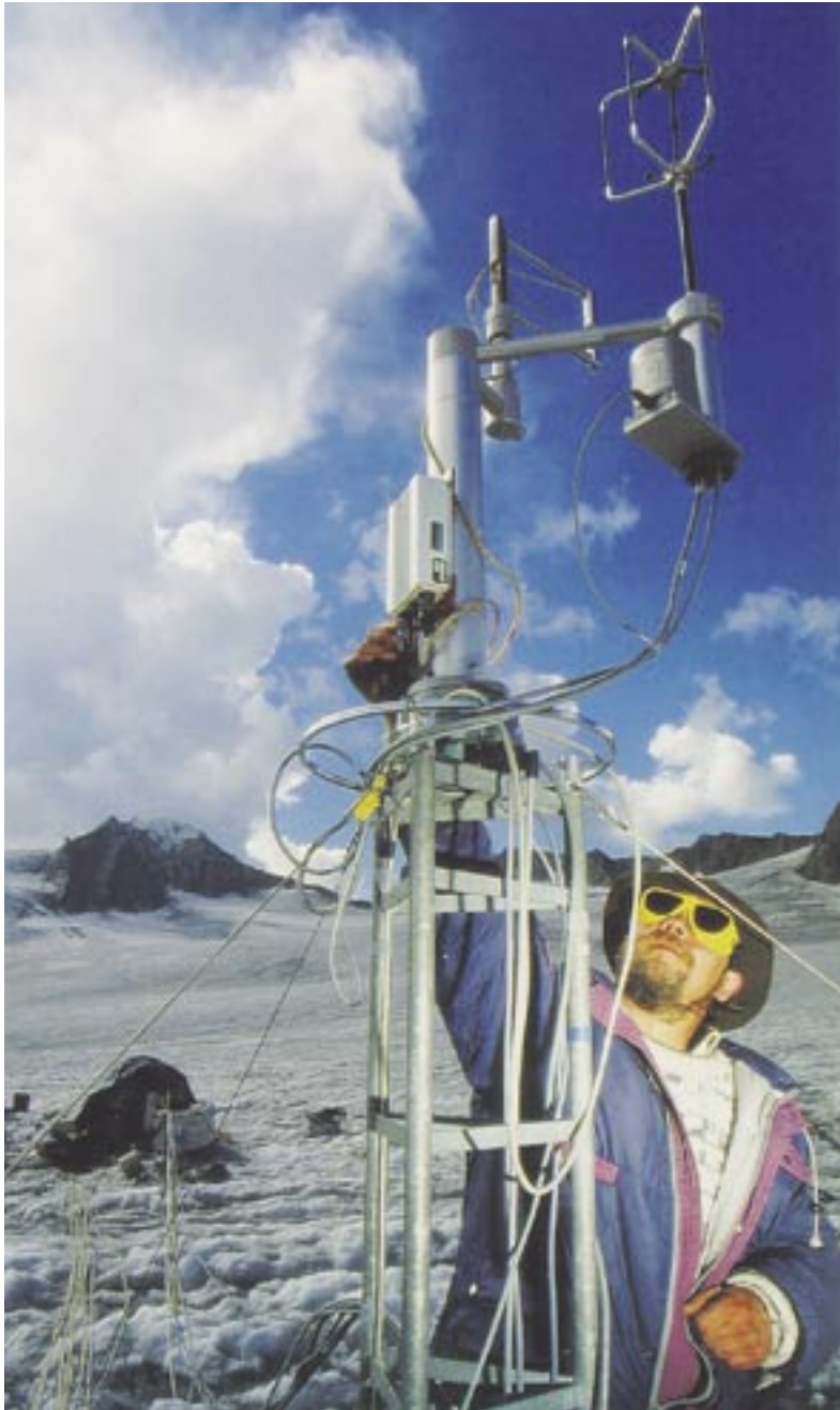
Betrieb einer mikrometeorologischen Turbulenzmesseinrichtung zur direkten Messung des Wärmeübergangs zwischen Atmosphäre und Eisoberfläche im August 1998 während der Feldmesskampagne HyMEX98 auf dem Vernagtferner. Im Hintergrund die Schutzzelte für die Messelektronik und die zugehörige Computeranlage.
