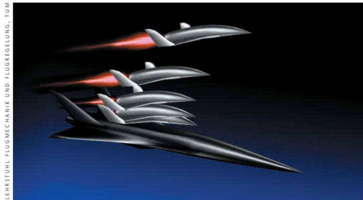
**Trennvorgang von Orbital- und Trägerstufe.** Die Trennung erfolgt in einer Höhe von ca. 35 km bei einer Geschwindigkeit von ca. 7500 km/h
