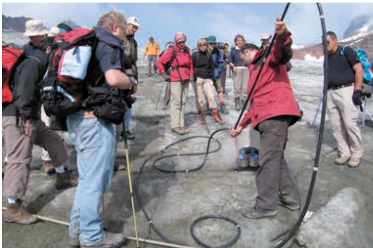
Eisbohrerarbeiten auf dem Vernagtferner. Mit heißem Dampf werden 10 bis 16 m tiefe Löcher in das Eis gebohrt, um die Abschmelzung an diesen Stellen mit Hilfe von Pegelstangen zu bestimmen.
