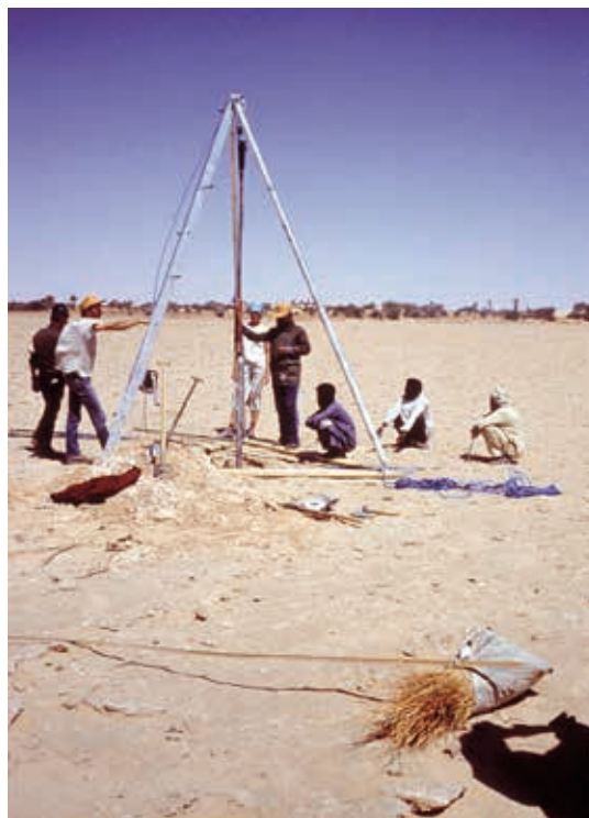
Abb. 5: Kernbohrung mit einem Kullenberg-Lot im Vorland der Schichtstufe von Emi Bao bei Seggedim.
