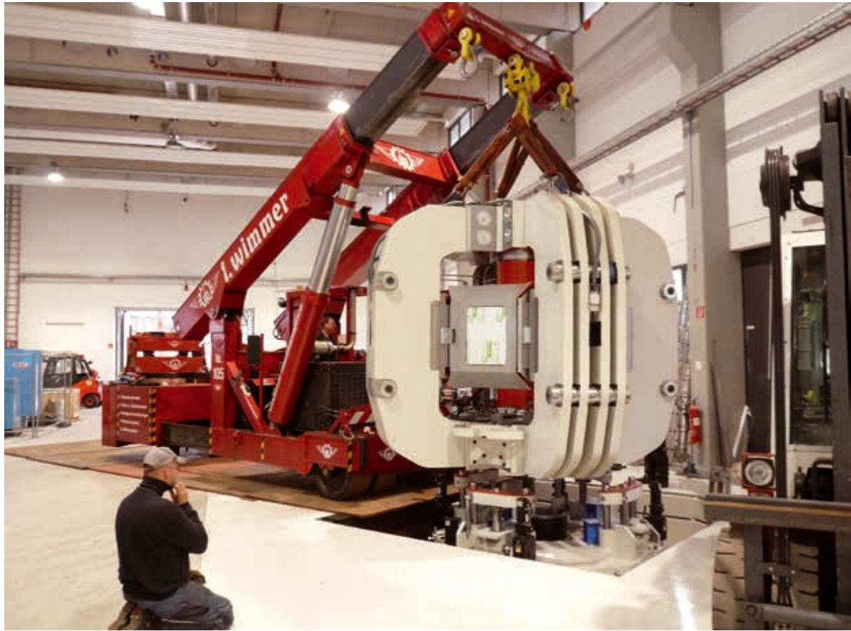
Abb. 4: Aufstellung der 6-Stempel-Hochdruckpresse. Der Positioniertisch von SAPHiR ist in einer Grube versenkt, so dass die Probenposition auf einer Höhe mit dem späteren Neutronenstrahl liegt.
