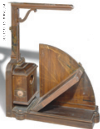
Apparat zur Demonstration des Reflexionsgesetzes beim Stoß nach Nollet; das Objekt war Teil des Polytechnischen Kabinetts. Die umfangreiche Instrumentensammlung von mehr als 2.000 Objekten schenkte die Akademie 1903 dem neu gegründeten Deutschen Museum für dessen Dauerausstellung.
