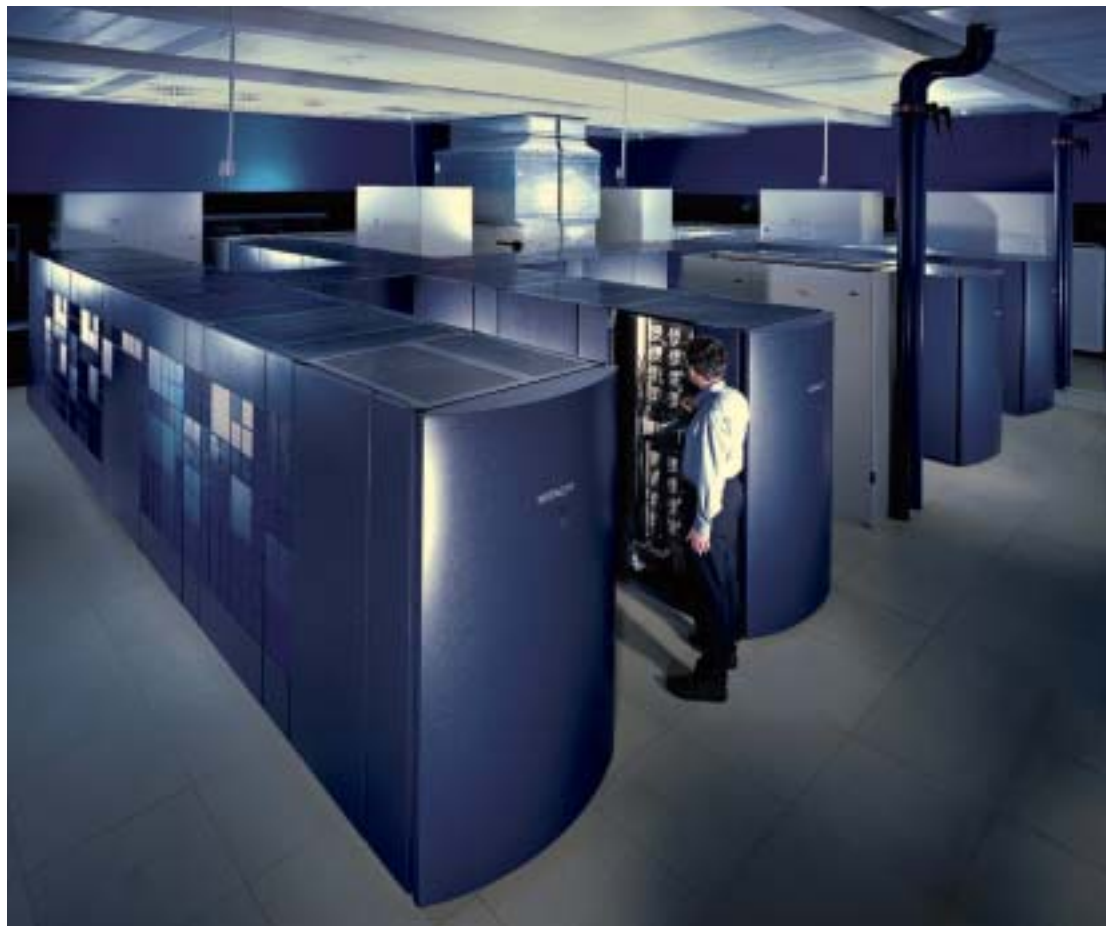
Die Hitachi SR8000-F1/168 im Rechenzentrum des LRZ. Die Gesamtlänge der Maschine beträgt zehn Meter, die maximale Breite acht Meter.
